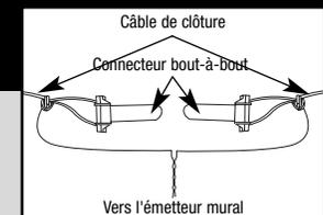
Raccordez les câbles de la boucle de confinement au câble torsadé à l'aide des connecteurs bout-à-bout étanches fournis. Connectez l'autre extrémité du câble torsadé à l'émetteur mural. Branchez l'adaptateur CA, connectez-le à l'émetteur et allumez celui-ci. Le témoin vert de l'émetteur doit s'allumer ; il indique que la boucle est fonctionnelle. Chargez le récepteur de votre collier en le plaçant dans la base de recharge qui se trouve sur le haut de l'émetteur.
