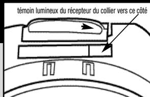
Positionnez le récepteur du collier dans sa base de chargement, sur le haut de l'émetteur mural. Orientez le témoin lumineux du collier vers l'extrémité de la base de chargement (voir la flèche et l'étiquette).
