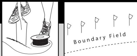
Creusez une tranchée de 7 cm et 10 cm de profondeur à l'aide d'une pelle-bêche. Pour aller plus vite, vous pouvez aussi utiliser un coupe-bordures à essence. Le fait de creuser la tranchée en angle vous aidera à maintenir le câble en terre au fur et à mesure que vous le mettez en place. Placez des fanions au niveau de la limite du champ de confinement, à l'endroit où le signal sonore commence à être audible et NON PAS au niveau du câble.
