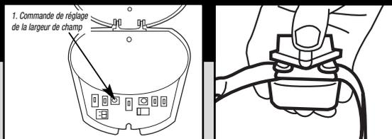
Mettez votre BOUTON DE RÉGLAGE DE LA LARGEUR DE CHAMP en position 9 heures. À l'aide du témoin lumineux de test fourni, emportez le collier du chien jusqu'au câble de clôture. Vous devez entendre un signal sonore de mise en garde et le témoin de test doit s'allumer. Refaites ce test en différents endroits de la clôture pour vérifier que la portée du dispositif est homogène.
